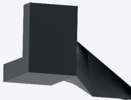
Вставыш – это маленькая пластмассовая вставка, разработанная специально для решения проблемы «линзы» внешнего угла. Вставыш устанавливается после того, как потолок полностью смонтирован и растянут, складки внешнего угла расправлены. Вставыш необходимо руками или утконосами установить на угол стены и утопить внутрь профиля
